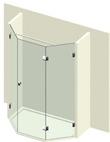
1 fix üvegről nyíló ajtó, 2 fix üveggel és 2 plusz oldalfallal
